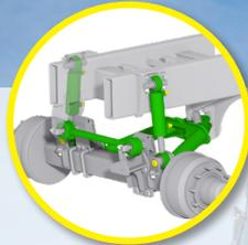
Tren de rodaje Hidro-Pendul con 2 ejes direccionales
