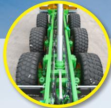
Bastidor estrecho - 2,55 m de ancho con ruedas de 600 mm
