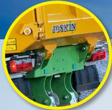
Puntos de bisagra ampliados para un vuelco estabilizado
